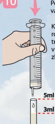
Pomocí pístu roztok protlačte přes vatový filtr.
